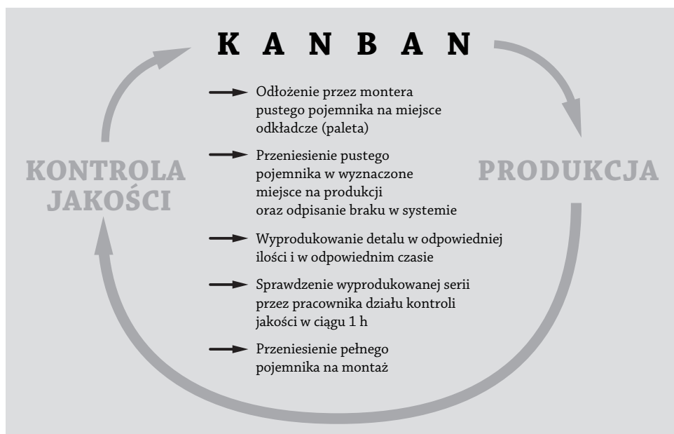
Rysunek 7.9. Schemat funkcjonowania w firmie systemu „Kanban-JIT” dotyczącego produkcji własnej
