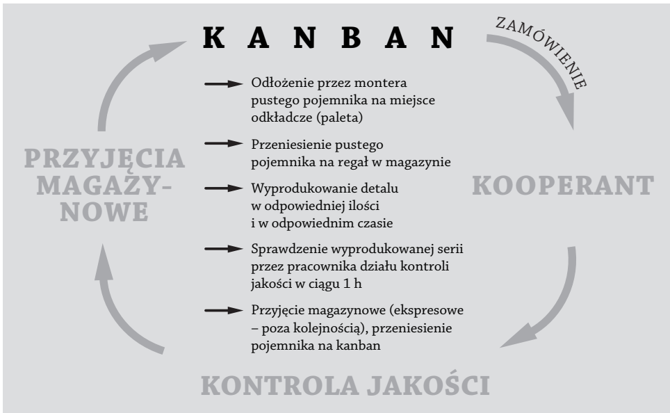
Rysunek 7.10. Schemat funkcjonowania systemu Kanban w firmie – kooperacja
